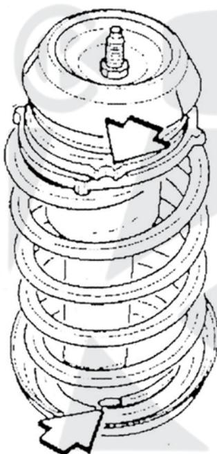
**Dica:** Atenção a posição do localizador. Do lado esquerdo os 2 dentinhos devem ficar apontados para a dianteira e do lado direito para a traseira do veículo.
