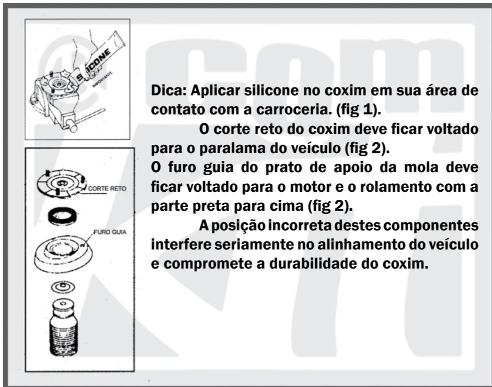
**Dica:** Aplicar silicone no coxim em sua área de contato com a carroceria. (fig 1).
